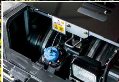
La urea se inyecta en los gases de escape para reducir las emisiones.
