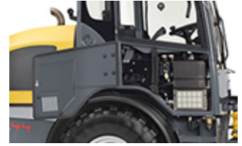
Serviceklappe an der Außenseite der Komfortkabine
