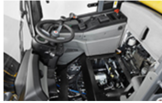
Wartungszugänge im Innenraum der Kabine
