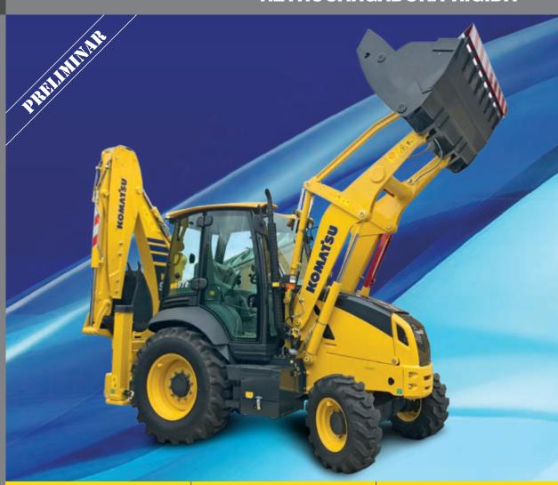
**POTENCIA DEL MOTOR** 75 kW / 101 HP @ 2.300 rpm **PESO OPERATIVO** 8.140 kg
