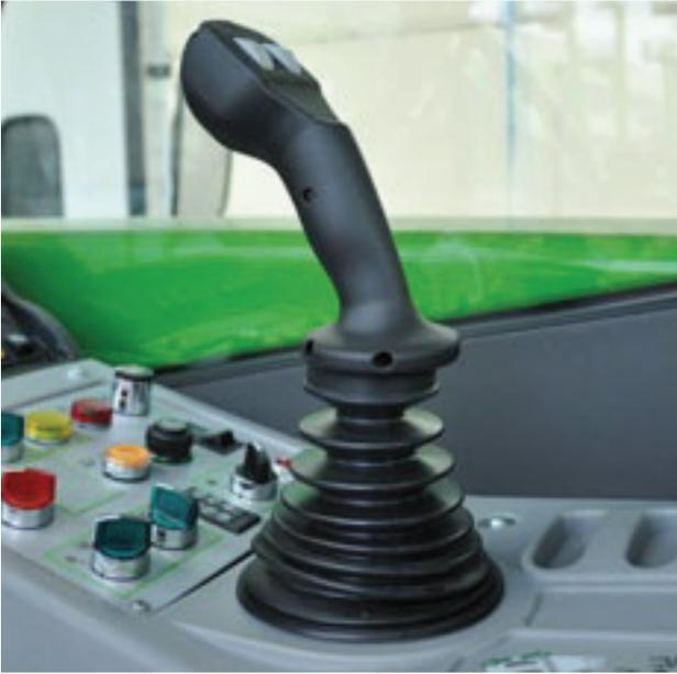
Der multifunktionale **Joystick-Bedienhebel** liegt ergonomisch in der rechten Hand. Je nach Modell arbeitet er entweder **proportional hydromechanisch** (Foto links) oder **vollelektronisch**.
