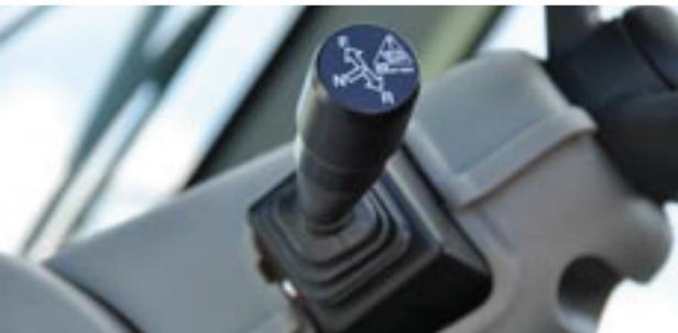
Ein **Finger-Touch-Schalter** an der Lenksäule erlaubt Fahrtrichtungswechsel, ohne die Hand vom Lenkrad zu nehmen.
