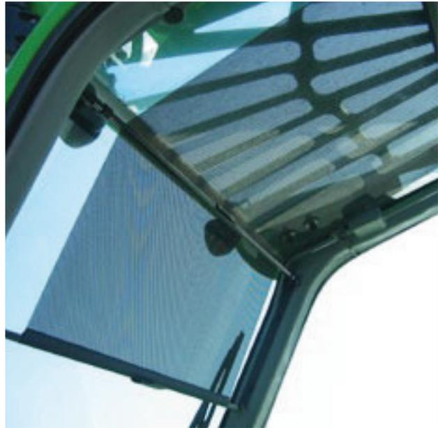
**Zweifach verstellbare Sonnenblenden** garantieren angenehmes Arbeiten selbst bei direktem Lichteinfall. Das **Dachfenster** ist mit Scheibenwischer ausgerüstet.
