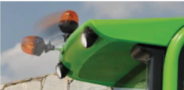
Das **abklappbare Rundumlicht** reduziert bei Bedarf die Kabinenhöhe. Aus demselben Grund ist der Kondensator der optionalen Klimaanlage bündig im Kabinendach untergebracht.
