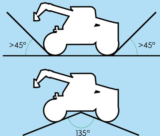
\* Die Durchschnittswerte variieren abhängig von den verwendeten Reifen. Die Maschine ist für das Überwinden von Gefällen von über 100 % ausgelegt worden (Wert kann in Abhängigkeit von der Bodenbeschaffenheit variieren).
