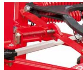
Bloqueo mediante un cilindro hidráulico con bulón
