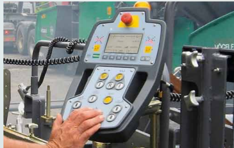
Le pupitre de commande ErgoPlus® du réglage
