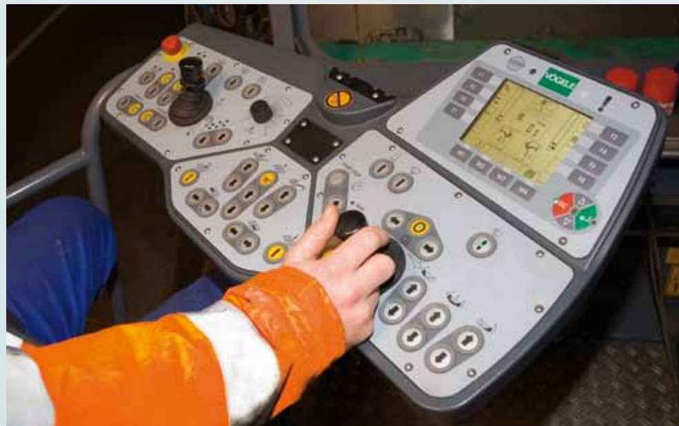
Le pupitre de commande ErgoPlus® du conducteur
