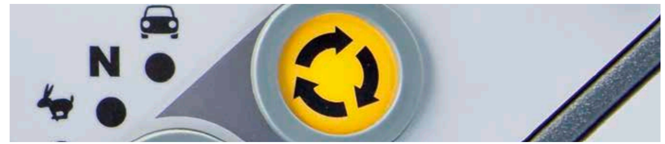
3 Invertir la marcha de las cintas transportadoras durante un corto período de tiempo
