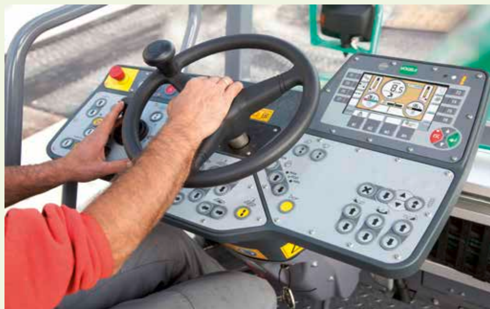
La consola de mando ErgoPlus 3 del operario
