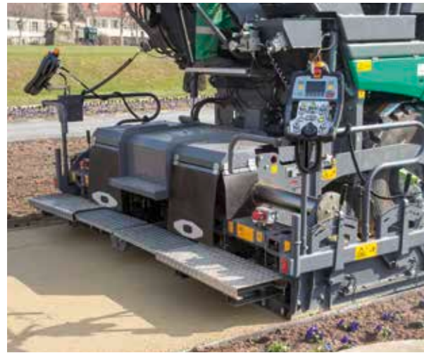
AB 340 TV con extensiones mecánicas de 25 cm
