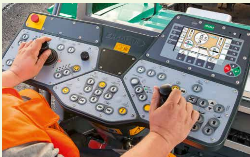
La consola de mando ErgoPlus 3 del operario
