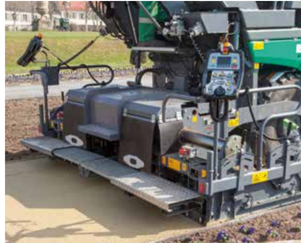
AB 340 V con extensiones mecánicas de 25 cm
