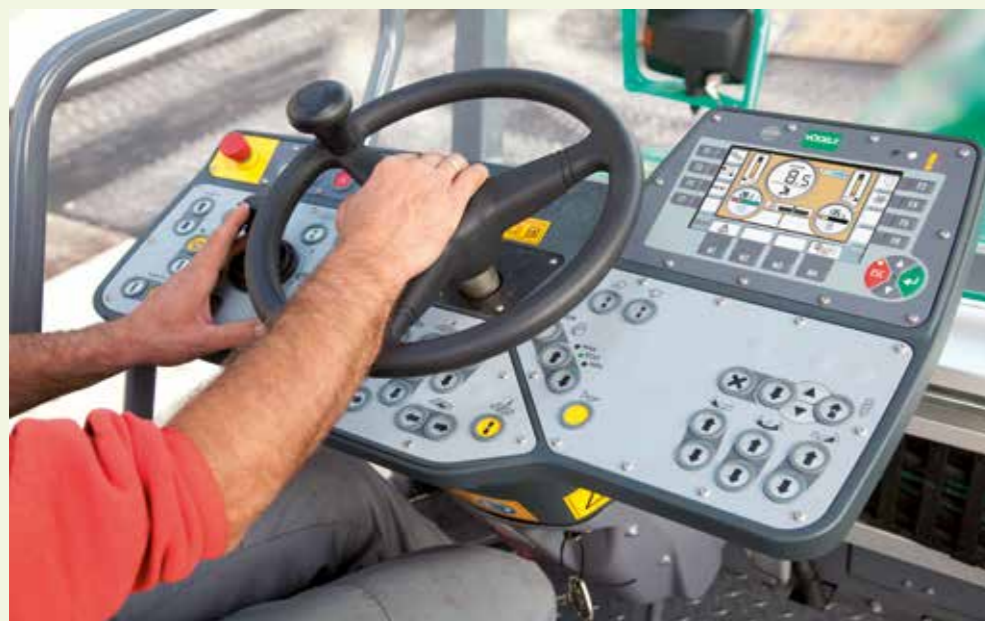
La consola de mando ErgoPlus 3 del operario
