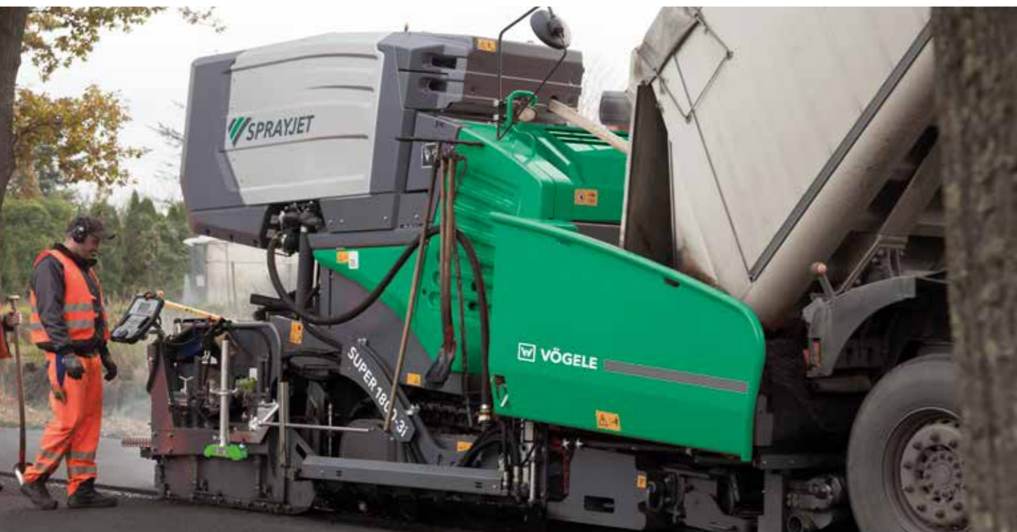
Die Antriebsstation des SUPER 1800-3i SprayJet erfüllt mit Dieseloxydationskatalysator (DOC), Dieselpartikelfilter (DPF) und selektiver katalytischer Reduktion (SCR) zur Abgasnachbehandlung die strengen Richtlinien der europäischen Abgasstufe V und der US-Norm EPA Tier 4f.
