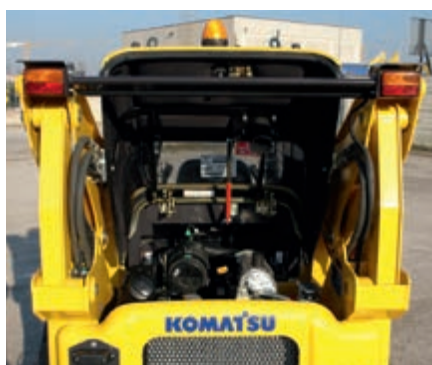
Kryt motoru: rychlá kontrola motoru
