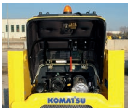
Kryt motoru: rychlá kontrola motoru
