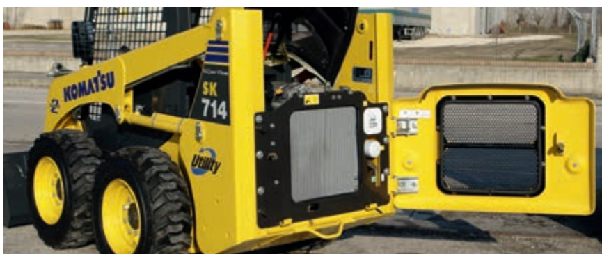
Zadní kryt: snadné provádění kontroly a čištění chladičů
