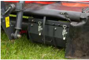
La largeur des andains est facilement réglable en déverrouillant et déplaçant latéralement les tôles d'andainage.
