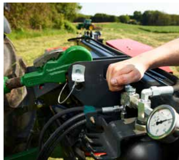
Réglage hydraulique de la pression au sol (EXTRA 432H et 436H).
