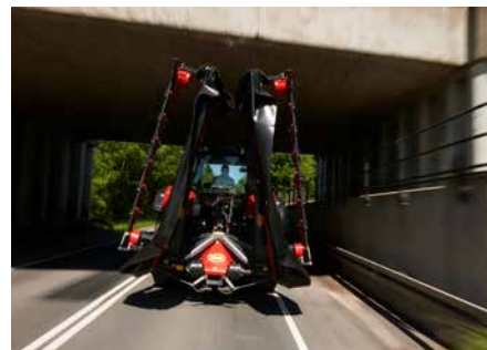
Transport en position verticale pour une répartition parfaite du poids.
