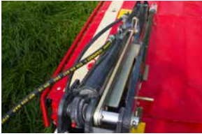
Relevage hydraulique en fourrière.
