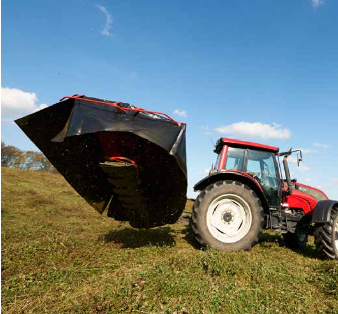
Relevage en bout de champ au moyen d'un vérin hydraulique.
