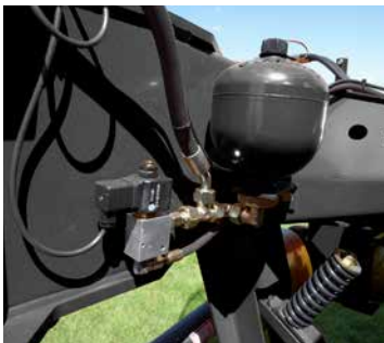
La suspension hydraulique assure un réglage précis de la pression au sol (EXTRA 440H).
