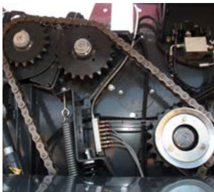
Die Heavy Duty 1¼ Zoll Antriebskette sorgt für hohe Einsatzsicherheit und niedrige Wartungskosten.
