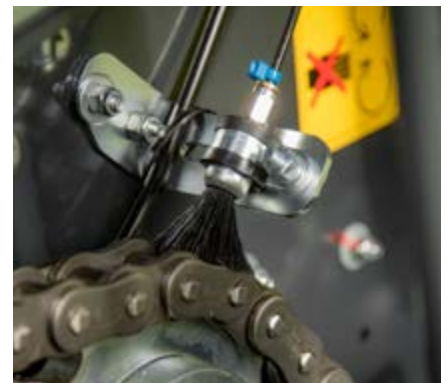
Serienmäßig automatische Kettenschmierung.
