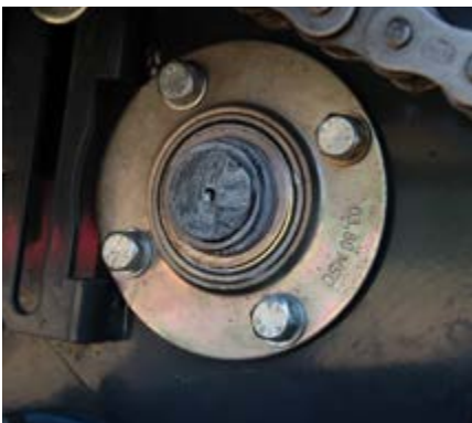
Jede Walze ist in Heavy Duty-Lagern gelagert.
