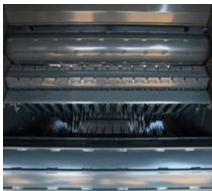
Das Ballenkammerkonzept enthält 5 Walzen im vorderen Bereich...
