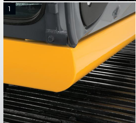
1. Les bâtis latéraux à profilés en D avec portes en retrait fournissent un maximum de protection à la cabine et aux composants.
