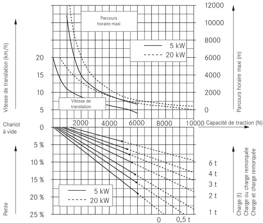
Si les caractéristiques des performances se situent au-delà des limites du diagramme, il faut choisir un moteur de 20 kW. La distance parcourue à l'heure, est la totalité du parcours aller-retour y compris les descentes. L'utilisation des remorques à frein est recommandée lorsque l'on roule sur des pentes.
