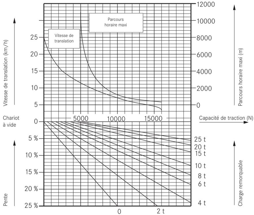
La vitesse autorisée, en fonction de la capacité de traction du tracteur, peut être comprise entre les 2 courbes pour s'adapter à l'application. La distance, parcourue à l'heure, est la totalité du parcours aller-retour y compris les descentes. Il est recommandé d'utiliser des remorques à frein si l'on roule sur des pentes et si les charges transportées sont supérieures à 9 tonnes.
