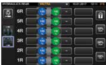
Puedes asignar cualquier control para trabajar con cualquier válvula, incluidas las válvulas hidráulicas delanteras, traseras, el elevador delantero, el elevador trasero y el cargador frontal.
