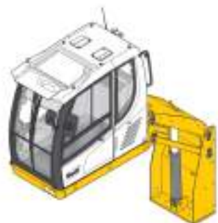
Rehausse de cabine hydraulique
