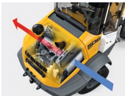
L'installation de réfrigération L 507/L 509
