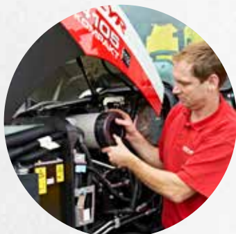
Ciągłe czyszczenie za pomocą filtra Piclon dba o to, aby filtr musiał być konserwowany tylko wtedy, gdy zaświeci odpowiednia lampka ostrzegawcza.
