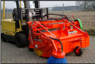
H-170-V-HT Gabelstapler Anbau, Seitenbesen, Sammelwanne
