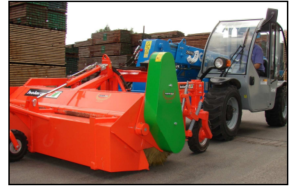
H-220-V Teleskoplader Anbau, Sammelwanne, CBS
