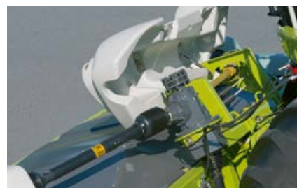
Protection optimale des puissants entraînements
