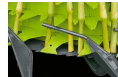
Transport doux des plantes et effet autoaffûtant des couteaux.
