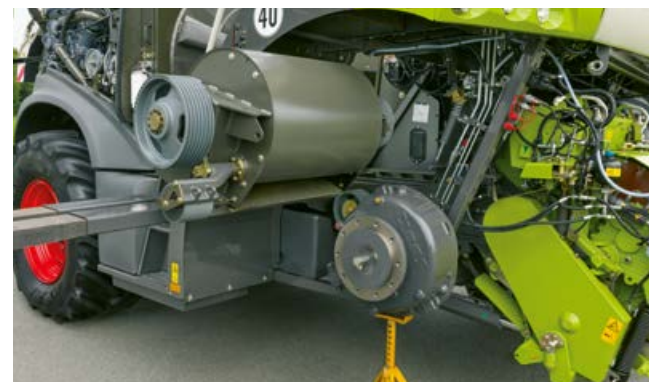
Simplicité pour le montage ou le démontage de l'accélérateur.
