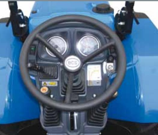
Die **ergonomischen Schalthebel** und **Pedale** sind logisch und intuitiv angebracht, damit der Fahrer immer die volle Kontrolle über den Traktor und die Arbeitsgeräte hat.
