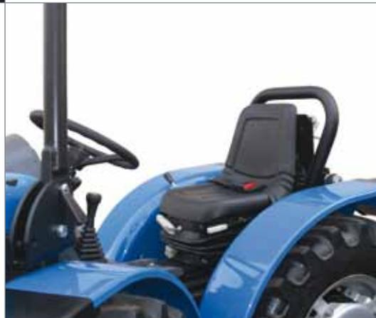
Der **vordere Schutzbügel** ist zugelassen und bietet einen sicheren Schutz für den Bediener. Der Fahrersitz ist gefedert und zugelassen mit Sicherheitsgurten.
