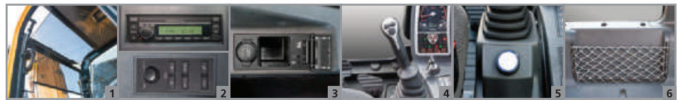
1. Aufrollbare Sonnenblende 2. Radio und MP3-Spieler mit Fernbedienung 3. Freisprecheinrichtung für Mobiltelefon 4. Ergonomische Joysticks 5. Einstellschalter für die Motordrehzahl mit LED 6. Aufbewahrungsfächer
