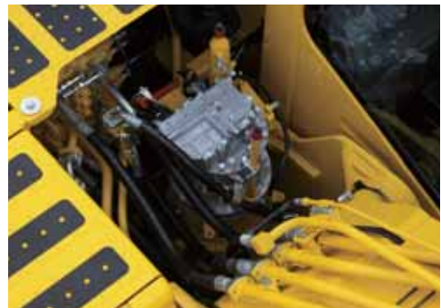
Der elektrische Schwenkmotor ersetzt den hydraulischen Schwenkmotor und ermöglicht die Rückgewinnung der Schwenkenergie als elektrischen Strom.
