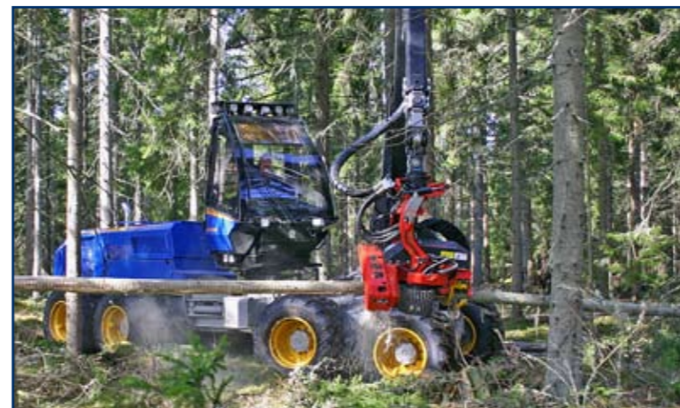
ROTTNE H-11 jest maszyną zwrotną i elastyczną, przez co doskonale daje sobie radę w ciasnych trzebieżach.
