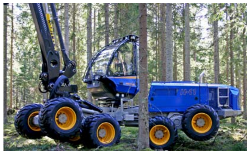
Bardzo mały promień skrętu dzięki funkcji podnoszenia osi podwójnej na obydwu osiach.
