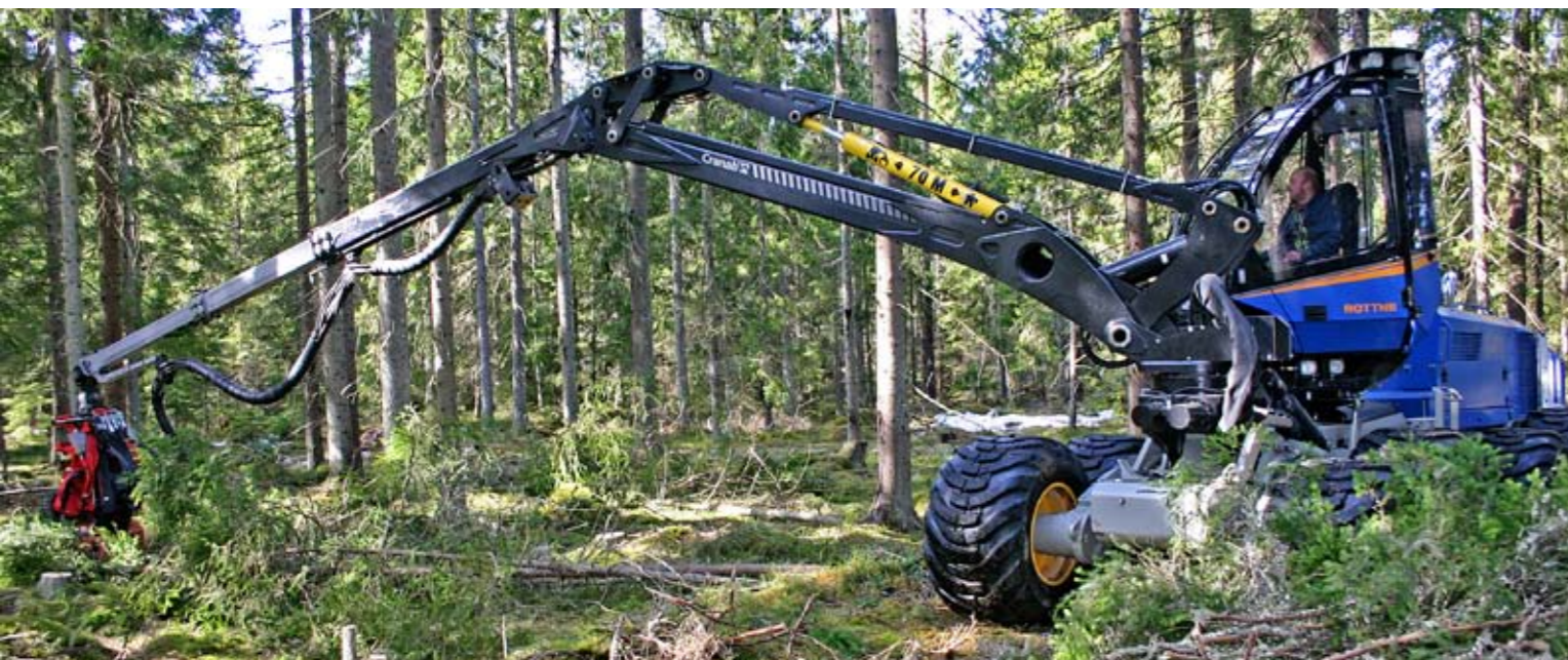
Mocny żuraw z podwójnym wysięgnikiem teleskopowym zapewniający zasięg 11,3 m.
