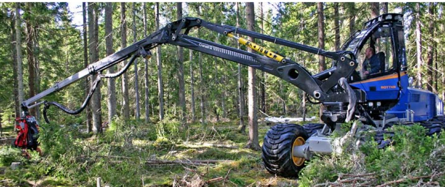
*Grue puissante avec double télescope et portée de 11,3 mètres*
