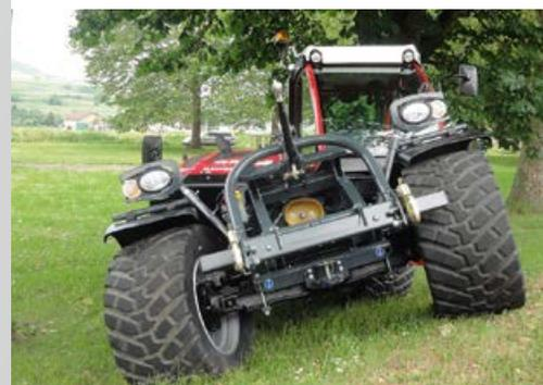
La junta articulada colocada en posición elevada dota al vehículo de una gran estabilidad para evitar el vuelco. El diseño de la junta articulada permite que el eje delantero tenga un rango muy amplio para pivotar, que dota a la máquina de excelente comodidad en la conducción y uso de aperos frontales.
