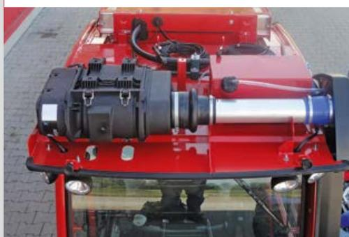
Toda el área de aspiración y la unidad del filtro de aire se encuentran por encima de la cabina del conductor.
