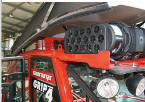
Los elementos del filtro de aire son fácilmente accesibles para su mantenimiento y limpieza tan sólo con elevar el techo de la cabina.
