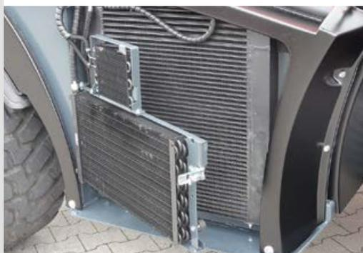
El radiador del aire acondicionado está situado en el lateral del cofre del motor para permitir la fácil limpieza con sólo abatir los segmentos individuales de los radiadores sin necesidad de herramientas. El equipo incorpora de un sistema para invertir el flujo de aire a demanda para así limpiar mejor los radiadores.
