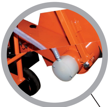
Wasserzuführung durch die Schneidwelle
