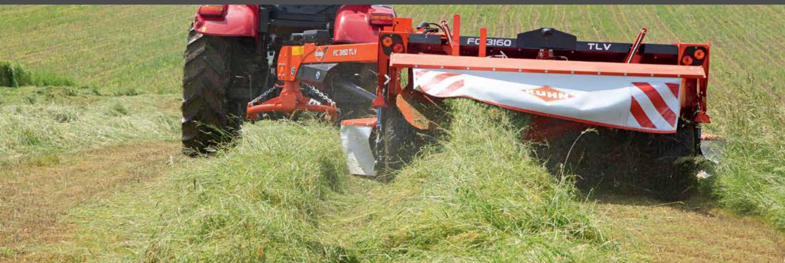
Con 3,10 m de corte, un acondicionador de mayales con dos velocidades y cubiertas de hilerado hidráulicas, la segadora acondicionadora FC 3160 TLV puede descargar 2 hileras en doble hilerado. Permite agrupar 6 m de siega en una hilera que no supera los 2,80 m. Una dimensión ideal para que lo recoja una ensiladora cuyo pick-up no exceda los 3 m.
