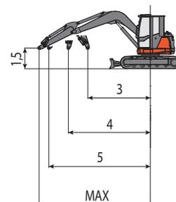
La capacidad de elevación se basa en la norma ISO 10567 y no excede el 75% de la carga estática de vuelco o el 87% de la capacidad de elevación hidráulica de la máquina.
