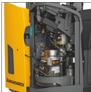
La tecnología de corriente trifásica de 36 V altamente eficaz de Jungheinrich
