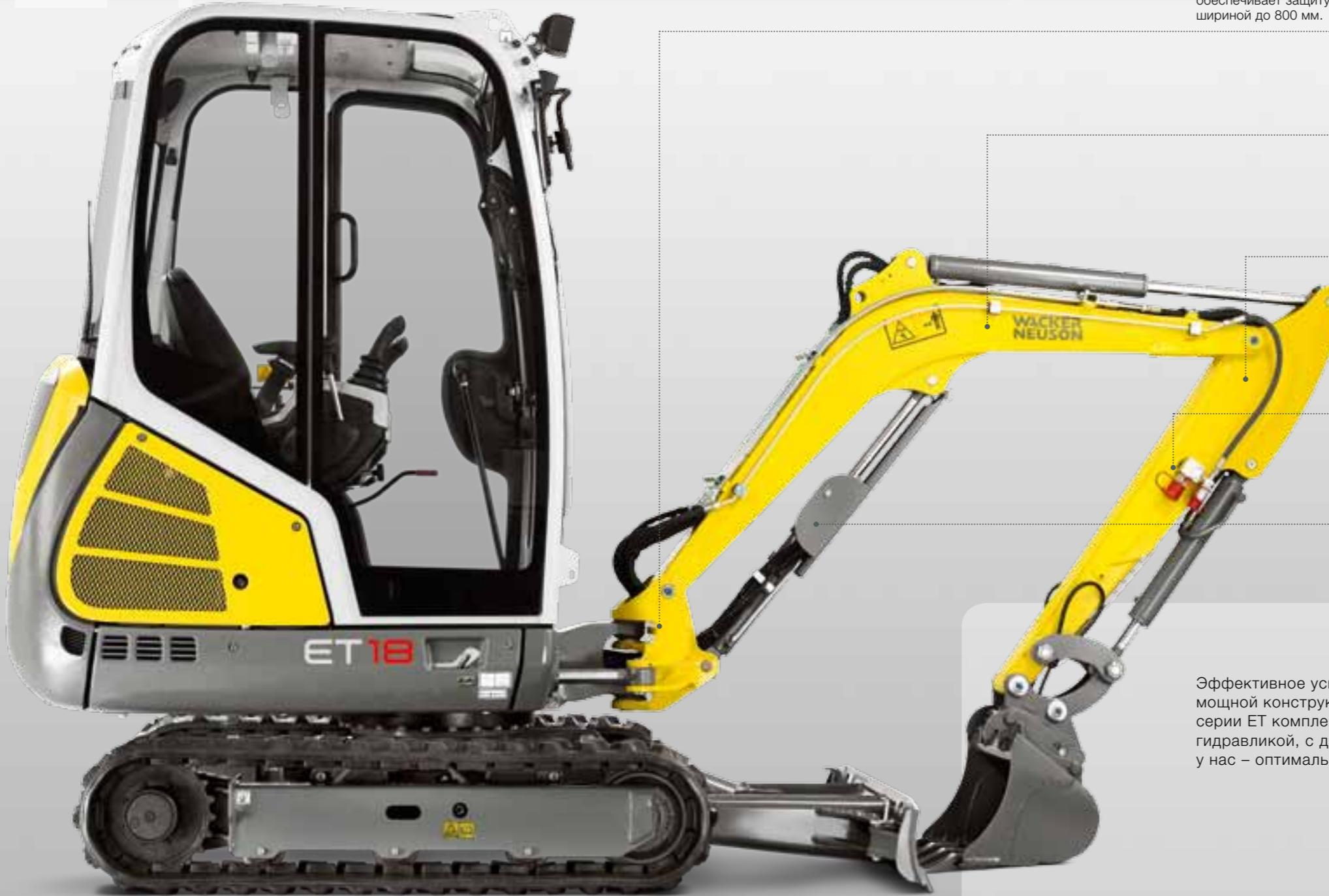
**Максимальный обзор и наилучшая защита.** Шланги от шасси в стреле проходят через 2-х элементную поворотную консоль. Это гарантирует полную защиту и отличный обзор во время работы.
