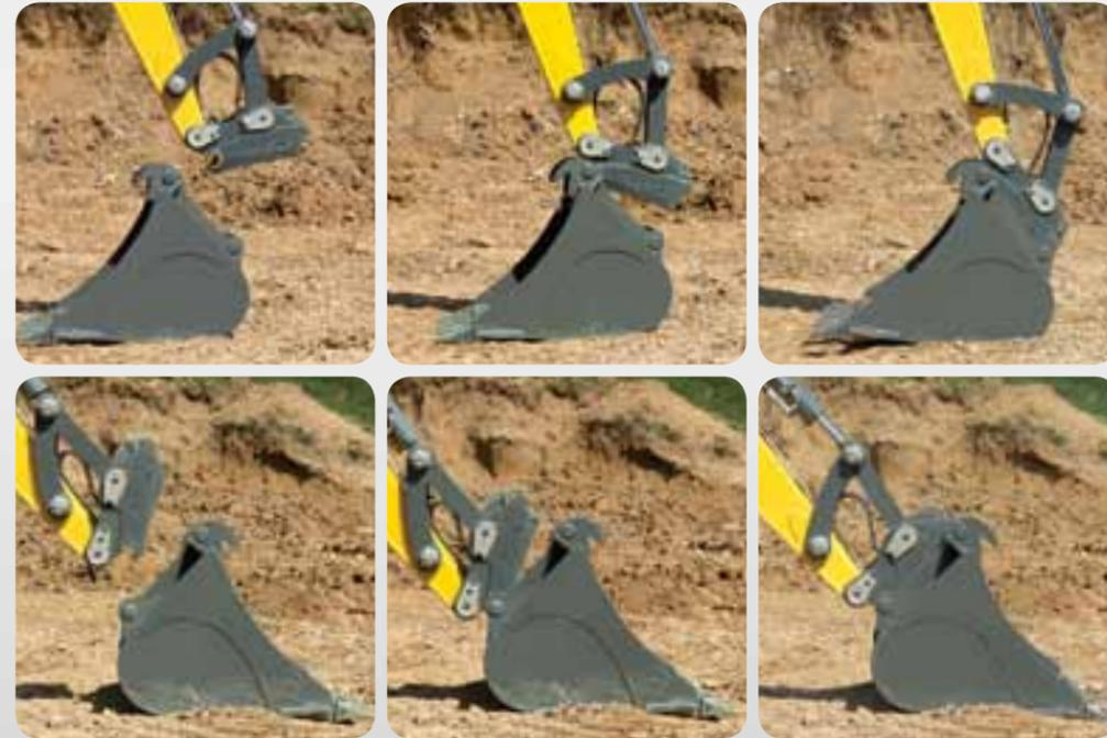
**Smart im Tief- und Hochlöfleinsatz.** Durch einfaches Drehen kann der Löffel auch als Hochlöffel eingesetzt werden. Das spart nicht nur Zeit, sondern steigert auf clevere Weise die Flexibilität des Baggers.
