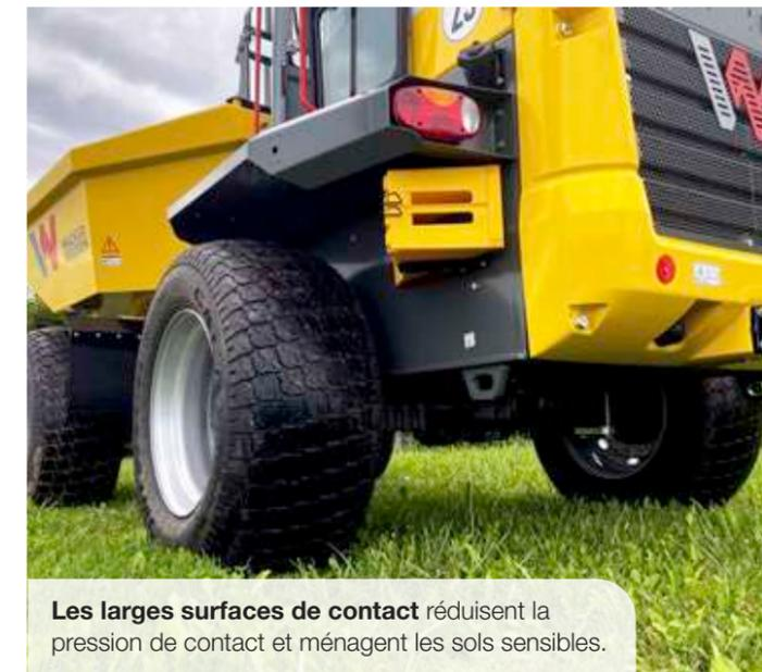
Les larges surfaces de contact réduisent la pression de contact et ménagent les sols sensibles.
