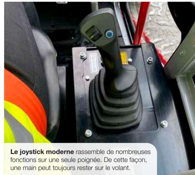
Le joystick moderne rassemble de nombreuses fonctions sur une seule poignée. De cette façon, une main peut toujours rester sur le volant.
