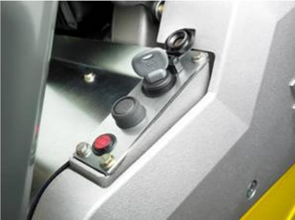
A versão de arranque eléctrico é facilmente accionada com a chave de ignição. Um sinalizador sonoro alto evita o descarregamento da bateria desnecessário.
