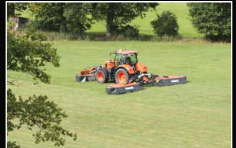
Die Mittenaufhängung garantiert einen gleichmäßigen Auflagedruck.
