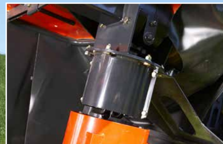
Direktantrieb vom Getriebe zur ersten Scheibe für effiziente Kraftübertragung.
