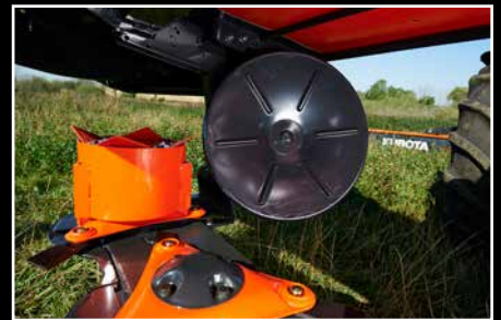
DM4028 und DM4032 sind mit einem Satz Schwadscheiben ausgestattet. Sie ermöglichen Schwadbreiten von 2,20-2,40 m.
