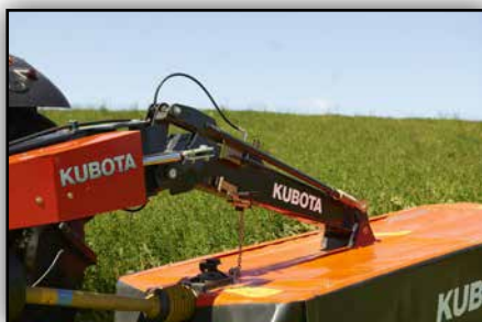
Die mittige Aufhängung des Mähbalkens sorgt für perfekte Boden Anpassung.
