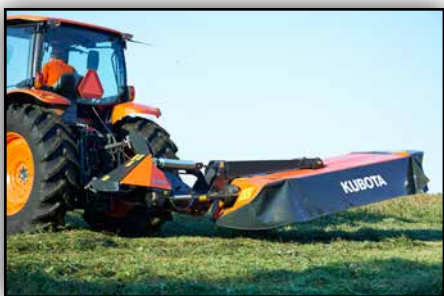
Am Vorgewende wird das Mähwerk über einen Hydraulikzylinder ausgehoben.
