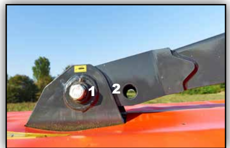
Zwei Anbaupunkte – das Heckmähwerk kann an das Frontmähwerk angepasst werden.
