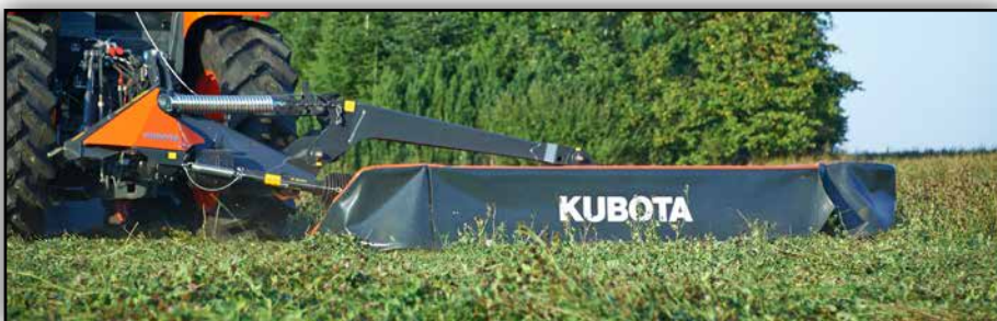
Die Mittelanhängung ermöglicht schnelle und präzise Boden Anpassung.
