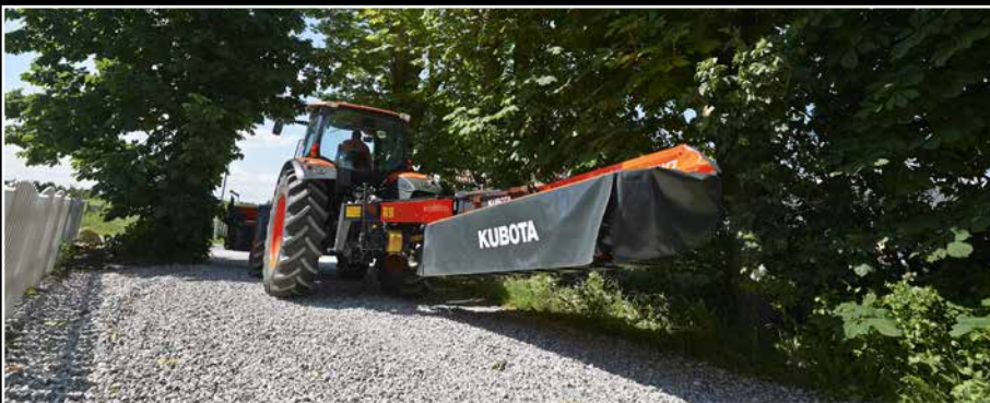
Für den Straßentransport wird das Mähwerk hydraulisch hinter den Schlepper geschwenkt.
