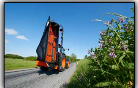
Für den Straßentransport wird die Maschine vertikal hinter den Schlepper geklappt.
