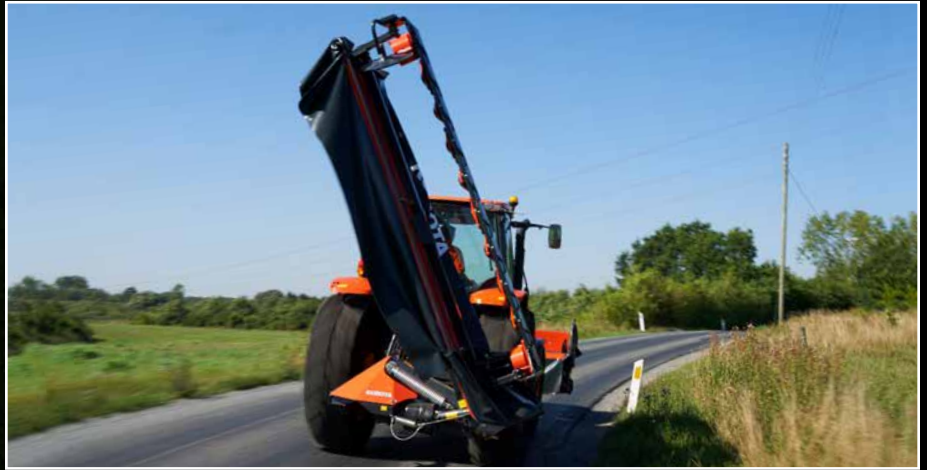
Für den Straßentransport wird das Mähwerk 125° eingeklappt.
