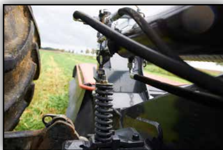
Trifft das Mähwerk auf ein Hindernis, weicht es nach hinten und gleichzeitig nach oben aus.
