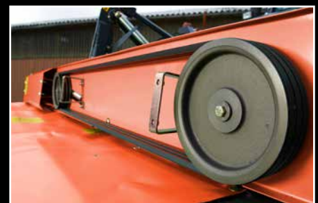
Durch Wechseln der Riemenscheiben kann das DM4000 mit 750 U/min gefahren werden. Dies spart Kraftstoff.
