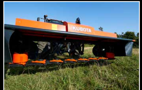
Optimaler Zugang zum Mähbalken durch klappbaren Front- und Seitenschutz.
