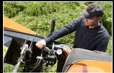
Hydropneumatisch Bodendruckentlastung und perfekte Boden-anpassung.
