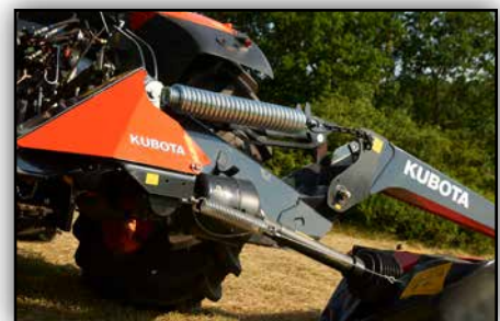
Große Entlastungsfedern garantieren immer eine optimale Bodendruckentlastung mit perfekter Boden Anpassung.
