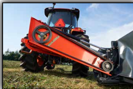
Vier Keilriemen sorgen für perfekte Kraftübertragung.
