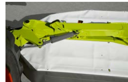
Ochrona hydraulicznym zabezpieczeniem najazdowym Nonstop w razie kolizji – zespół tnący odchyła się i samoczynnie ustawia w pozycji wyjściowej.
