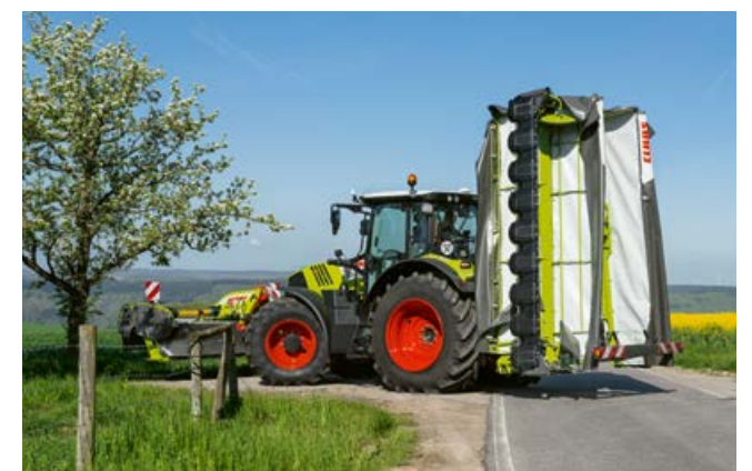
Poniżej 4 metrów wysokości i całkowicie kompaktowa, jak wszystkie modele DISCO: przed złożeniem oba zespoły tnące są po prostu zsuwane na teleskopach.
