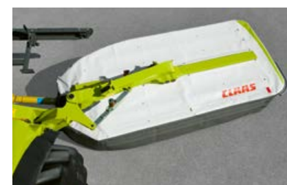
Mechaniczne zwolnienie zabezpieczenia najazdowego: w przypadku kolizji maszyna odchyła się do tyłu i lekko w górę (w DISCO 1100 TREND hydrauliczne zabezpieczenie najazdowe Nonstop).
