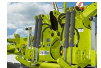
Seryjne siłowniki podnoszenia i odciążania w systemie ACTIVE FLOAT gwarantują pracę ze znakomitą ochroną darni.
