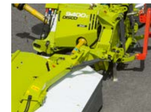
Ochrona hydraulicznym zabezpieczeniem najazdowym Nonstop w razie kolizji – zespół tnący odchyła się i samoczynnie ustawia w pozycji wyjściowej.
