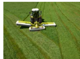
Podnoszenie pojedyncze zespołów tnących na nawrotach.
