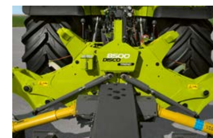
Kompaktowy i stabilny zaczep z seryjnie montowanym systemem odciążenia ACTIVE FLOAT.
