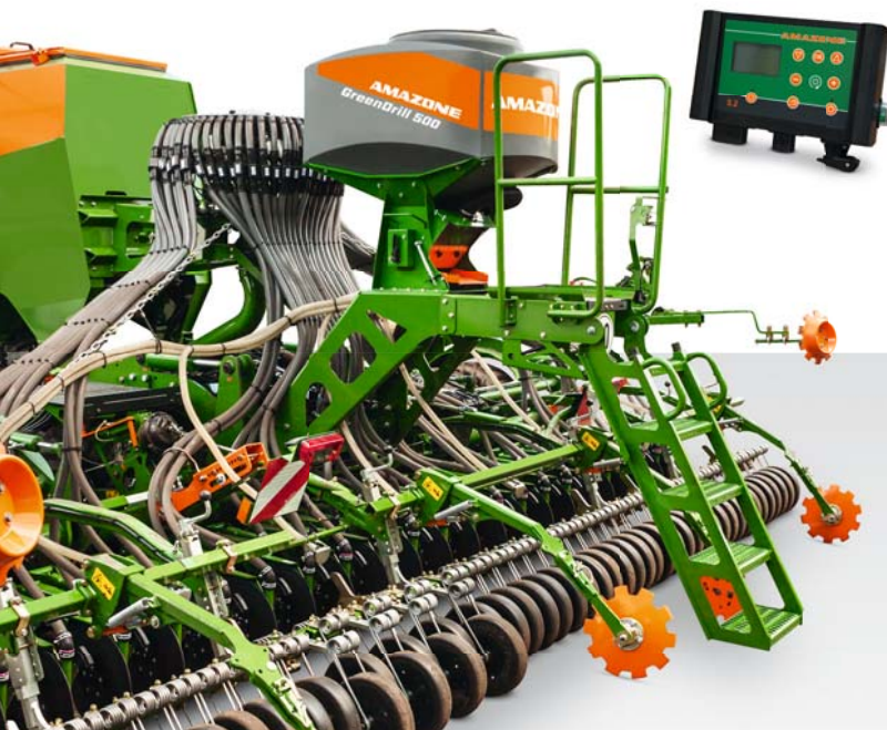
GreenDrill 500 op de Cirrus 6003-2C, voor onderzaaien of slakkenkorrels geschikt
