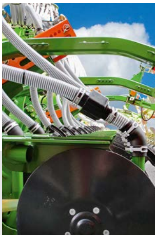
Capteur pour saisir le flux de semence sur le soc semeur
