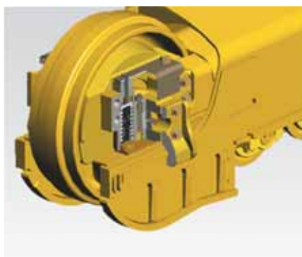
Vodící kolo s automatickým napínáním pásu
