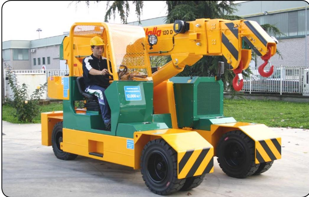
**TELESCOPE:** construit à partir de plaques d'acier soudées, de haute qualité, composé de 3 éléments 1 fixe et 2 télescopiques à commande hydraulique se déployant sur des patins de frottement nylon.
