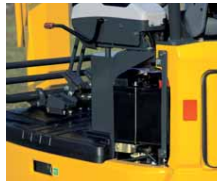
Linker kap: gemakkelijke toegang tot de accu
