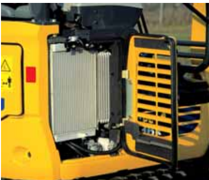
Rechter kap snelle controle en reiniging van de radiatoren
