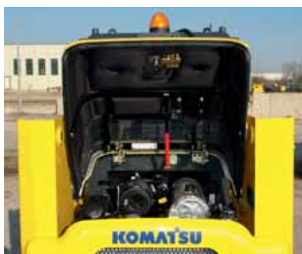
Kryt motoru: rychlá kontrola motoru
