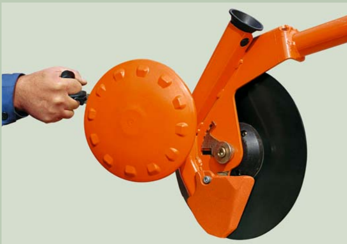
Für sehr große Ablagetiefen wird die Tiefenführungsscheibe mit einem Handgriff ganz abgenommen.
