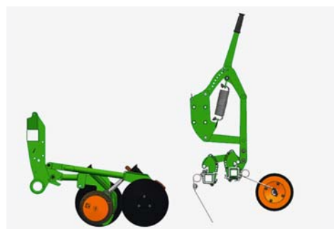
Rollenbalk uitgeschakeld: de sleeptandeneg bedekt alleen het zaad met grond.
