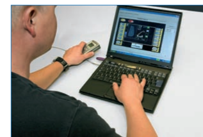
El Sistema de asistencia técnica a distancia Bronto Tele-Control permite la transferencia directa entre el sistema de diagnóstico y el servicio técnico homologado Bronto. Un análisis de avería así como su puesta en marcha vía satélite garantizan su fiabilidad y rapidez en el servicio técnico.
