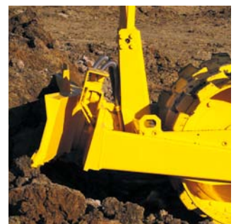
Planierschild mit hydr. Tilteinrichtung
