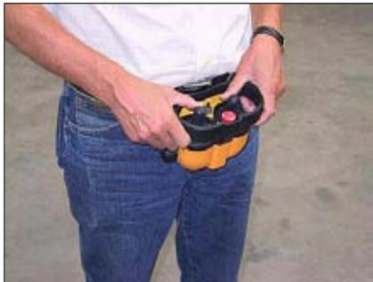
Bedienung des Fahrtriebes: Standard mit Kabelfernsteuerung, Option mit Funkfernbedienung.
