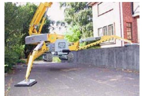
Die speziell konstruierten Stützen ermöglichen eine optimale Aufstellung der Bühne - auf Neigungen bis auf 40% (21,8°).
