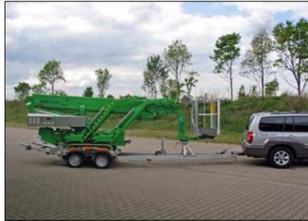
Transport auf Spezialanhänger. Bis einschließlich Typ 2200 ist das Gesamtgewicht unter 3500 kg.
