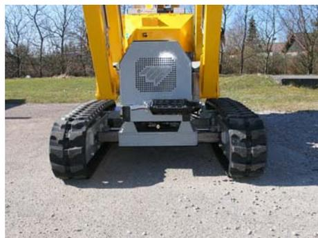
Die Bühnen sind als Option mit verstellbarer Spurweite, hydraulisch justierbar von 1,1 m bis 1,5 m, lieferbar.
