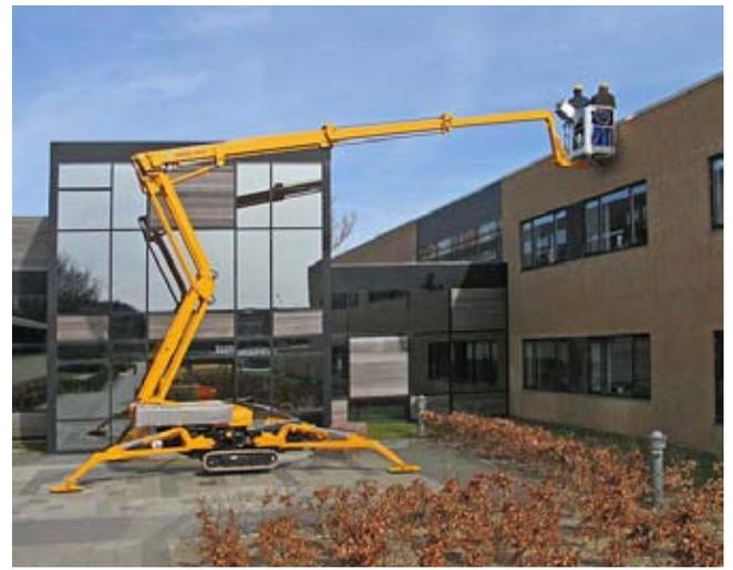
Die Kombination von Scherensystem und Teleskopausleger ermöglicht eine einfache Reichweite über Hindernisse.
