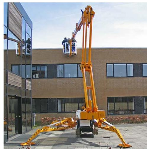
Die Bühne kann auch einseitig schmal abgestützt werden, um die Arbeitsbreite zu reduzieren. Jedoch verringert sich dadurch der Schwenkbereich.
