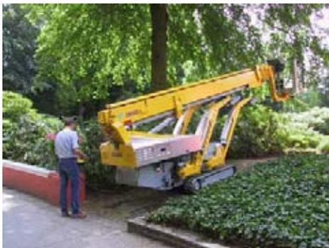
Die maximale Steigfähigkeit von 40 % (21,8°) und die Transportbreite von nur 1,1 m ermöglichen ein sehr benutzerfreundliches Manövrieren.
