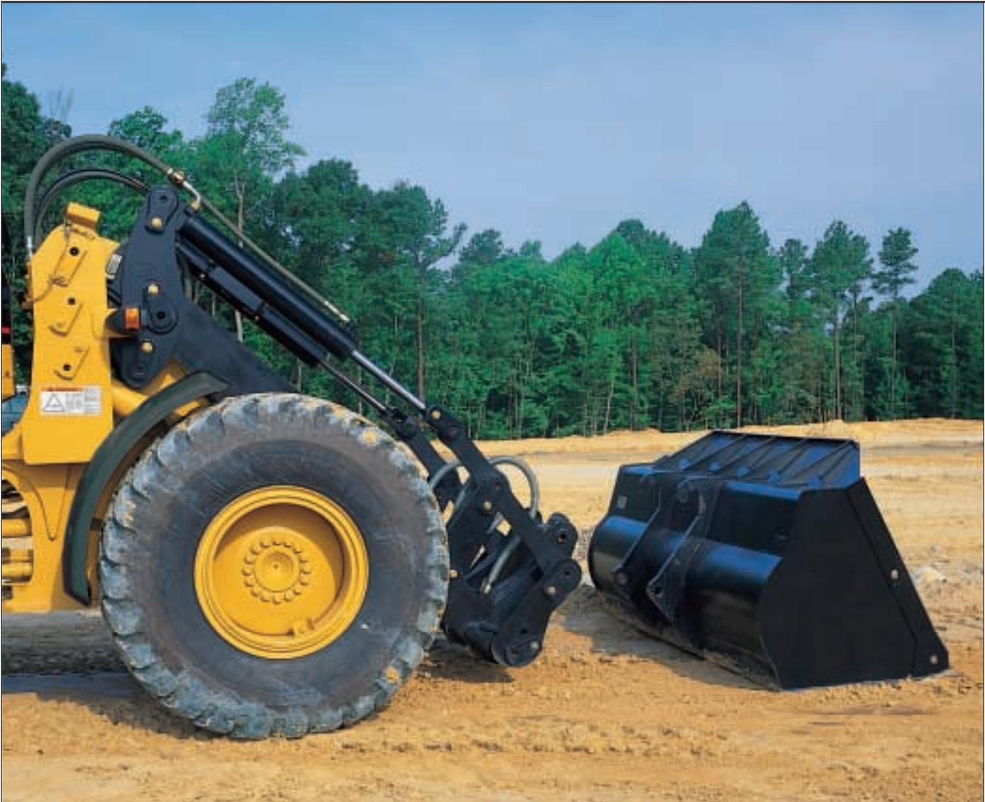
**Praktischer Schnellwechsler.** Die hydraulisch betätigte SWE ist ein integraler Bestandteil der Ladeeinrichtung. Ein Hebel in der Kabine gestattet den raschen Austausch der Anbaugeräte vom Fahrersitz aus – ein Vorgang, der nicht einmal 30 Sekunden in Anspruch nimmt. Serienmäßige Schnellverschlußkupplungen ermöglichen einen raschen Anschluß von hydraulisch betätigten Arbeitswerkzeugen.
