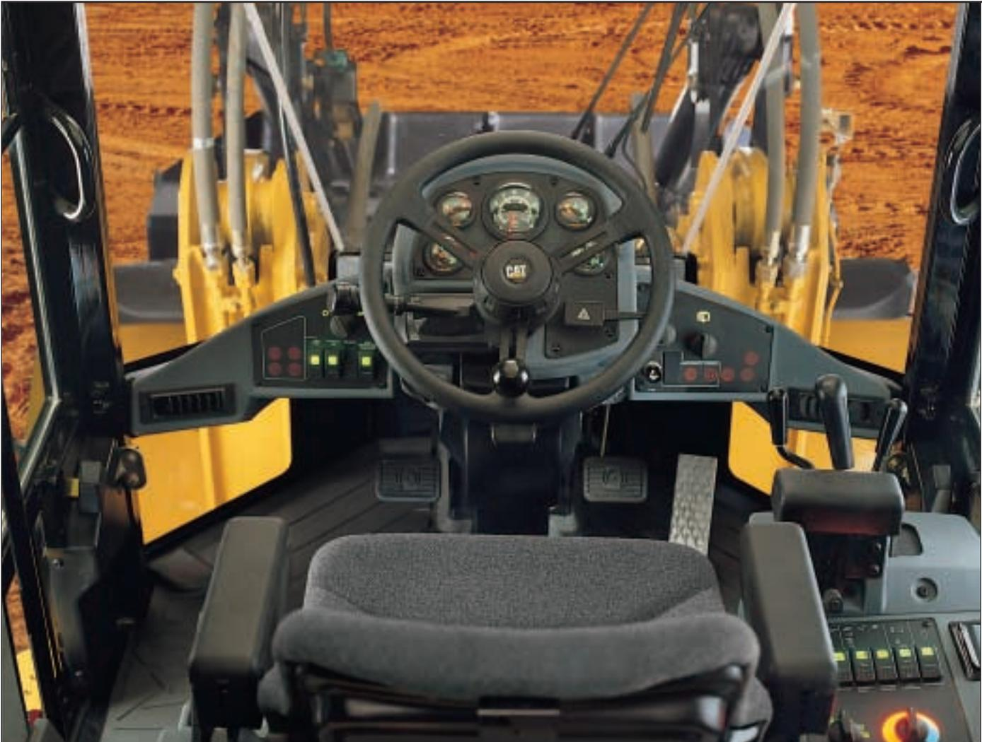
In der geräumigen und bequemen Kabine, die mit Hilfe von Super-Computern und Virtueller Realität konstruiert wurde, kann der Fahrer des IT28G ausdauernd, sicher und produktiv arbeiten. Fenster und Innenabmessungen wurden merklich vergrößert, die Anordnung der Bedienelemente verbessert und mehr Ablagemöglichkeiten geschaffen. Hinzu kommt eine drastische Reduzierung des Lärmpegels, die für wohltuende Ruhe im Kabineninneren sorgt.
